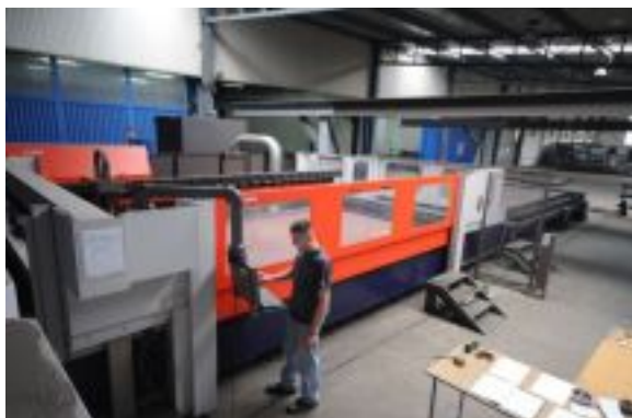
CNC mašina za lasersko sečenje (Bystronic Laser AG), laserska glava 6000 W, radni sto 2.5m x 6.5m Zoom
